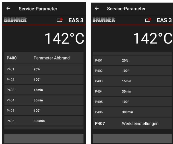
Параметры прожига можно сбросить, нажав на последний параметр **Заводские настройки** (= Werkseinstellungen). Для этого во всплывающем меню необходимо подтвердить пункт **Сбросить сейчас** (= Jetzt rücksetzen).
