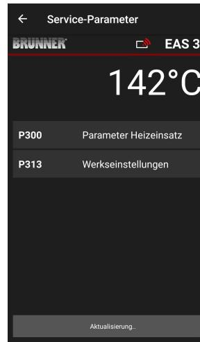
Na automatische verzending van de gegevens verschijnen de huidige waarden voor elke parameter voor het ingestelde verwarmingselement onder **P300 Parameter Heizeinsatz = P300 Parameters verwarmingselement.**
