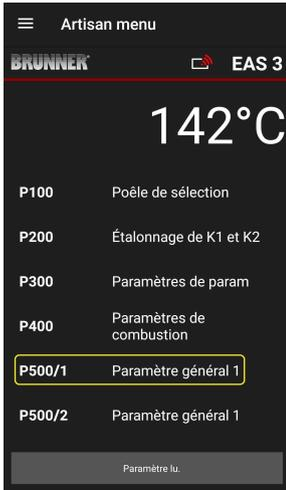
Dans ce menu, on peut régler les paramètres généraux partie I (P501 - P512). Les plages de valeurs sont visibles dans le *guide de programmation (chapitre paramètres généraux)*.
