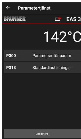
På **P300 Parametrar Värmeinsats** visas efter automatisk överföring av data de aktuella värdena per parameter för den inställda värmeinsatsen.
