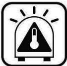
Temperaturen i brennkammeret er over den tillatte verdien for varme- eller peisinnsetsen.
