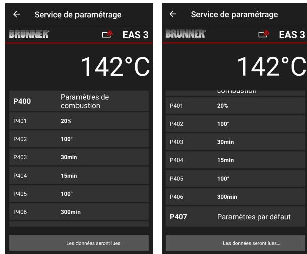
Les paramètres de combustion peuvent être réinitialisés en cliquant sur **Réglages d'usine (= Werkseinstellungen)**. Pour cela, il faut confirmer le menu contextuel en cliquant sur **Réinitialiser maintenant (= Jetzt rücksetzen)**.
