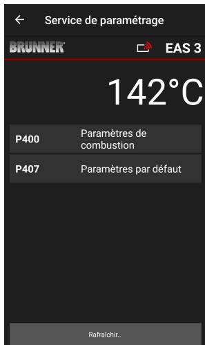
Sous **Paramètres de combustion (Parameter Abbrand)** apparaissent, après transmission automatique des données, les valeurs actuelles par paramètre pour le foyer défini.
