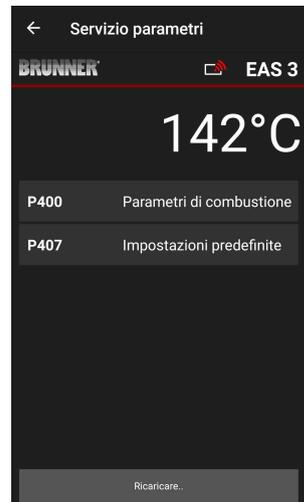
Sotto **Parametri combustione** compaiono in automatico i dati trasmessi, i valori attuali per ogni parametro dell'inserto impostato.
