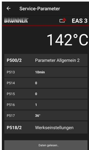
Parametrii pentru burn-off pot fi resetați fără să clic pe ultimul parametru **Werkseinstellungen = Factory settings (Setări de fabrică)**. Pentru a face acest lucru, meniul pop-up trebuie confirmat cu **Jetzt rücksetzen = Reset now (Resetare acum)**.
