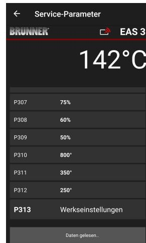
Varmeelementparametrene kan tilbakestilles ved å klikke på **den siste parameteren Fabrikkinnstillinger**. For å gjøre dette må lokalmenyen bekreftes med **Jetzt rücksetzen= Tilbakestill nå**.
