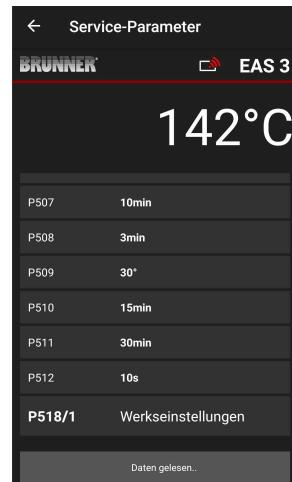
De parameters voor de burn-up kunnen gereset worden door op de laatste parameter **Werkseinstellungen = Fabrieksinstellen-** gen te klikken. Hiervoor moet het pop-up-menu bevestigd worden met **Jetzt rücksetzen = Reset nu.**
