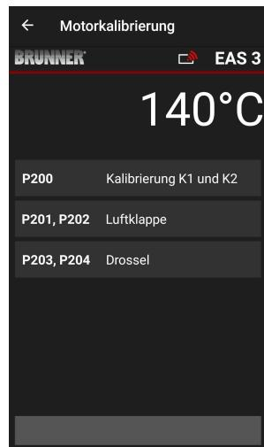
Stlačte tlačidlo **Start (Spustiť) P201** → Motor sa spustí na 100 %, ak sa tak ešte nestalo, potom sa spustí na 0 %. Motor je teraz možné kalibrovať ručne. Ak to chcete urobiť, stlačte tlačidlo + alebo -.
