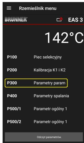
W tym menu można ustawić parametry wkładu. Zakresy wartości ustawień można sprawdzić w *instrukcji programowania* (rozdział *Parametry wkładu*).
