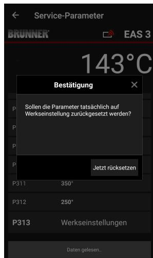
De parameters van het verwarmingselement kunnen worden gereset door op **de laatste parameter Fabrieksinstellingen** te klikken. Hiervoor moet het pop-upmenu bevestigd worden met **Jetzt rücksetzen = Reset nu**.
