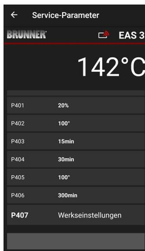
Parametry pro vypalování lze resetovat kliknutím na poslední parametr **Tovární nastavení (= Werkseinstellungen)**. K tomu je třeba potvrdit vyskakovací nabídku příkazem **Resetovat nyní (= Jetzt rücksetzen)**.
