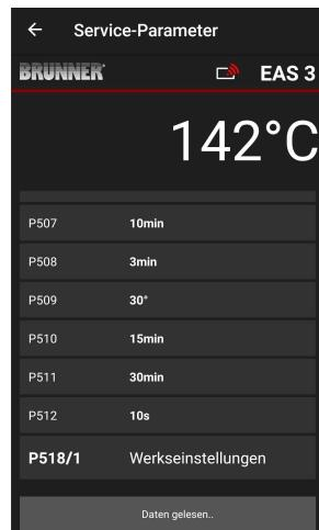
Parametrii pentru burn-up pot fi resetați fără să clic pe ultimul parametru **Werkseinstellungen = Factory settings (Setări de fabrică)**. Pentru a face acest lucru, meniul pop-up trebuie confirmat cu **Jetzt rücksetzen = Reset now (Resetare acum)**.
