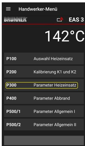
В этом меню можно задать параметры для нагревательного элемента. Диапазоны значений приведены в *инструкции по программированию* (глава «*Параметры нагревательного элемента*»).
