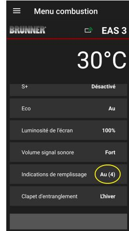
La configuration sélectionnée est indiquée entre parenthèses sous le menu de la combustion. (ici exemple: configuration 4)
