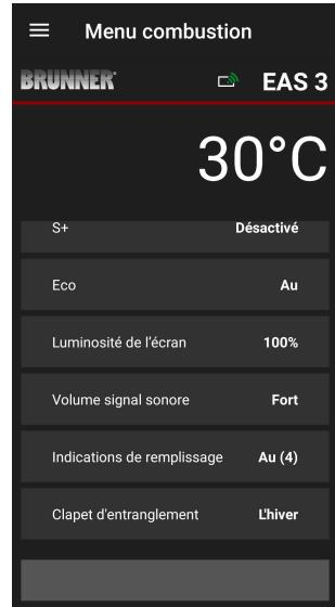
L'appui sur le bouton Menu combustion = **Ab-brand-Menü** ouvre le menu avec les paramètres qui peuvent être réglés.
