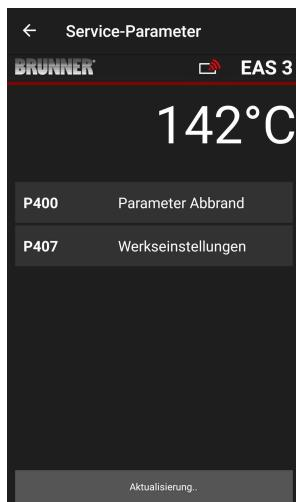
Po automatickom prenose údajov sa v časťi **Burn-up parameters (Parametre vy- paľovania) (= Parameter Abbrand)** zo- brazia aktuálne hodnoty jednotlivých pa- rametrov pre nastavené vykurovacie teleso.
