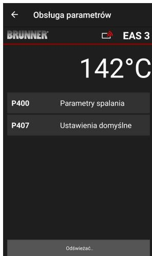
Po automatycznym przekazaniu danych, w punkcie **Parametry spalania** pokazują się aktualne wartości poszczególnych parametrów dla ustawionego typu wkładu.
