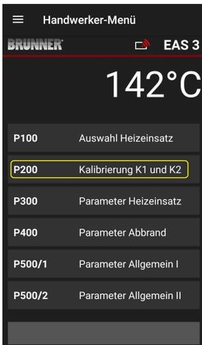
Stlačením tlačidiel **Kalibrierung K1** a **K2 = Kalibrácia K1 a K2** sa otvorí **P200** pre kalibráciu motora.
