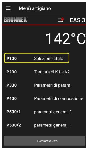
Premendo il tasto **Auswahl Heizeinsatz** si apre il menù P100. Cliccando sulla riga dell' inserto **calorifico (= Heizeinsatz)** si apre un menù Popup.
