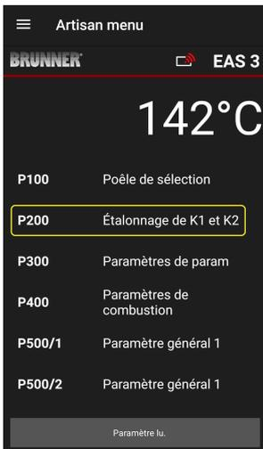
En appuyant sur le bouton Calibrage K1 et K2, **Kalibrierung K1 und K2** le menu P200 **P200 Menü** s'ouvre pour le calibrage du moteur.
