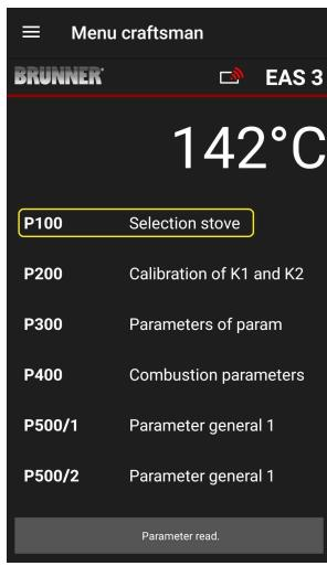
Press the **Select heater button** (=Auswahl Heizeinsatz) to open the P100 menu. Click on the row with the **heater (=Heizeinsatz)** type indication to open a pop-up menu.
