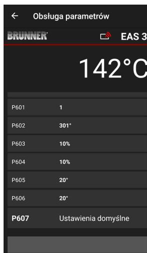
Wartości parametrów od P602 do P606 są wyświetlane, jeżeli P601 ma ustawienie „1”, tzn. konfiguracja obejmuje szyber:
