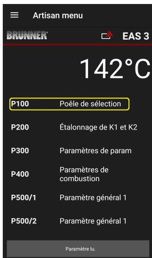
En appuyant sur le bouton **Poêle de sélection/(Auswahl Heizeinsatz)**, le menu P100 s'ouvre. En cliquant sur la ligne correspondant à l'insert de **chauffage (Heizeinsatz)**, un menu contextuel s'ouvre
