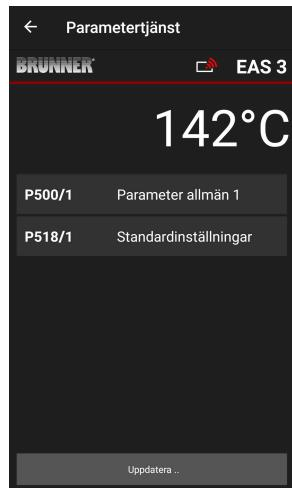
På P500/1 Parametrar Allmänt 1 visas efter den automatiska överföringen av data de aktuella värdena per parameter.
