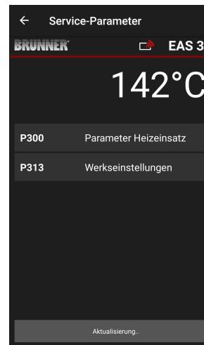
Etter automatisk overføring av data vises de aktuelle verdiene for hver parameter for det installerte varmeelementet under **P300 Parametere for varmeelement =Parameter Heizeinsatz**.
