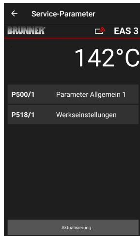
De aktuelle verdiene for hver parameter vises under **P500/1**. **Generell parameter =Parameter Allgemein 1** etter at dataene er overført automatisk.
