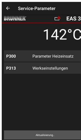
Po automatickom prenose údajov sa v časti **P300 Parameter Heizeinsatz = P300 Parameter vyku** rovacieho telesa zobrazia aktuálne hodnoty jednotlivých parametrov pre nastavené vykurovacie teleso.
