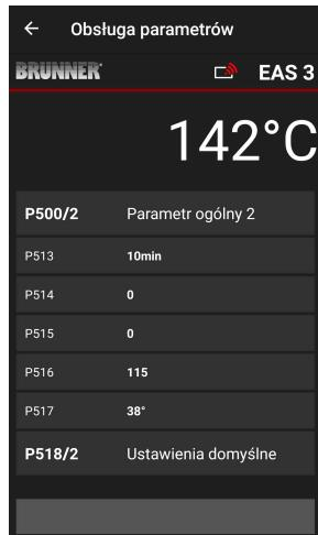
Parametry spalania można zresetować, klikając **Ustawienia fabryczne (= Werkseinstellung)**. W tym celu na pytanie trzeba odpowiedzieć **Zresetuj teraz (= Jetzt rücksetzen)**.
