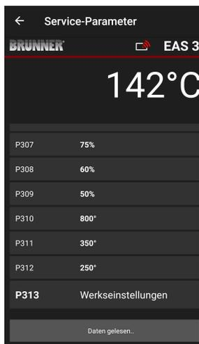
Parametry topného prvku lze resetovat kliknutím na **poslední parametr Tovární nastavení**. K tomu je třeba potvrdit vyskakovací nabídku příkazem **Jetzt rücksetzen = Resetovat nyní**.
