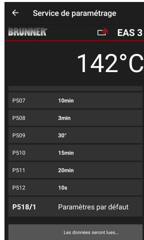
Les paramètres de combustion peuvent être réinitialisés en cliquant sur **Réglages d'usine (Werkseinstellungen)**. Pour ce faire, le menu contextuel doit être confirmé par **Réinitialiser maintenant (Jetzt rücksetzen)**.
