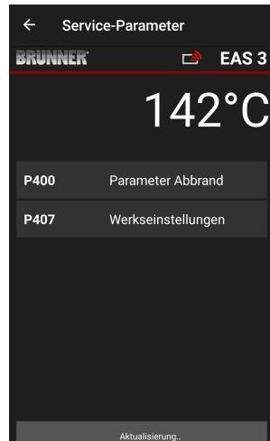
После автоматической передачи данных в разделе «**Параметры горения**» (= Parameter Abbrand) появляются текущие значения каждого параметра для заданного нагревательного элемента.
