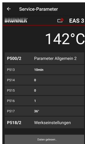
Parametre pre vypálenie je možné resetovať kliknutím na posledný parameter **Werkseinstellungen = Továrenske nastavenia**. Na tento účel je potrebné potvrdiť vysúvaciu ponuku príkazom **Jetzt rückgesetzt = Resetovať teraz**.
