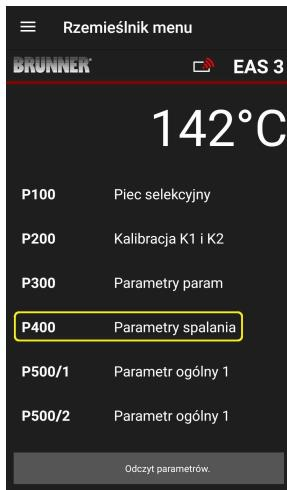
W tym menu można ustawić parametry procesu spalania. Zakresy wartości ustawień można sprawdzić w *instrukcji programowania* (rozdział *Parametry spalania*).
