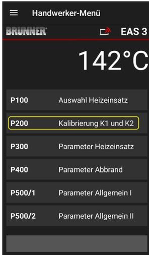
Нажатие кнопок **Kalibrierung K1 und K2** = Калибровка K1 и K2 открывает меню **P200** для калибровки двигателя.
