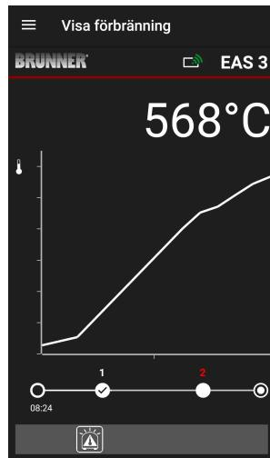
Om det finns ett tändningsfel visas det på tidslinjen (timeline) på följande sätt (rött):
