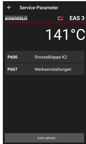
Aktuální hodnoty jednotlivých parametrů se po automatickém přenosu dat zobrazí v položce **P600 Škrticí klapka K2 (= P600 Drosselklappe K2)**:
