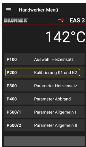
Stlačením tlačidiel **Kalibrierung K1 und K2 = Kalibrácia K1 a K2** sa otvorí **P200** pre kalibráciu motora.
