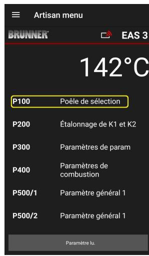
En appuyant sur le bouton **Poêle de sélection/(Auswahl Heizinsatz)**, le menu P100 s'ouvre. En cliquant sur la ligne correspondant à l'insert de chauffage (Heizinsatz), un menu contextuel s'ouvre
