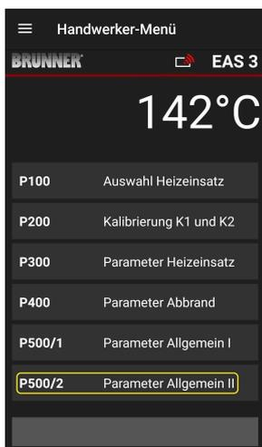
I denne menyen kan du stille inn de generelle parametrene del 2 (P513 - P517). Verdiområdene finner du i *programmeringsveiledningen* (kapittelet *Generelle parametere*).
