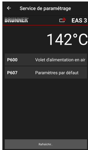
Sous P600 Clapet d'étranglement K2 (**Drosselklappe K2**) , les valeurs actuelles de chaque paramètre apparaissent après la transmission automatique des données:
