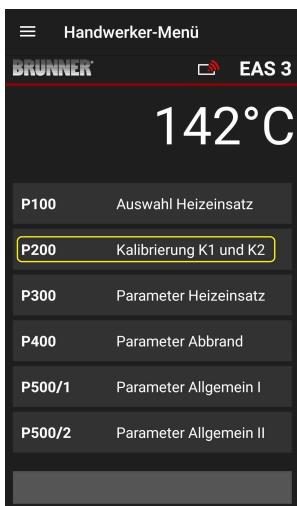
Når du trykker på knappene **Kalibre-ring K1 og K2 =Kalibrerung K1 und K2**, åpnes meny-en **P200-menyen** for motorkalibrering.
