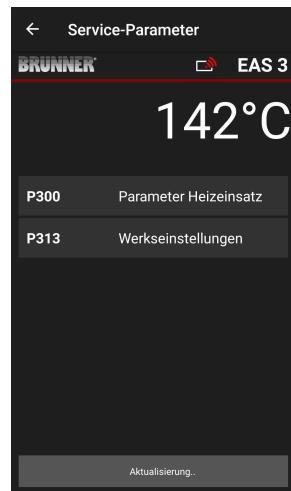
Po automatickém přenosu dat se v části **P300 Parameter Heizeinsatz = P300 Parametry** topného prvku zobrazí aktuální hodnoty jednotlivých parametrů pro nastavený topný prvek.
