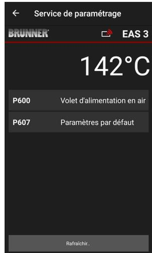
Sous P600 Clapet d'étranglement K2 (**Drosselklappe K2**), les valeurs actuelles de chaque paramètre apparaissent après la transmission automatique des données:
