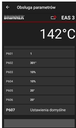
Wartości parametrów od P602 do P606 są wyświetlane, jeżeli P601 ma ustawienie „1”, tzn. konfiguracja obejmuje szyber:
