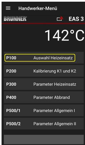
Stlačením tlačidla **Auswahl Heizeinsatz** = **Vybrať vykurovací prvok** otvorte ponuku P100. Kliknutím na riadok s vykurovacím **Heizeinsatz** = **prvkom** otvorte vyskakovacie menu.
