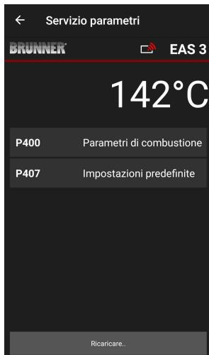
Sotto **Parametri combustione** compaiono in automatico i dati trasmessi, i valori attuali per ogni parametro dell'inserto impostato.
