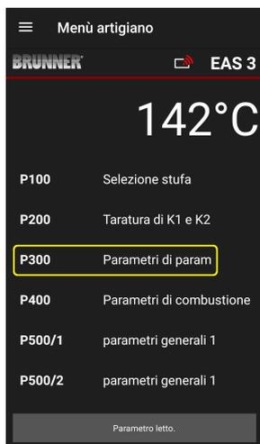
In questo menù si possono impostare i parametri per l'inserto calorifico.
