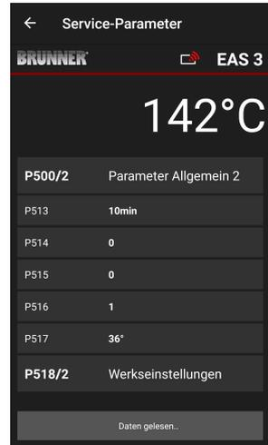
Parametry pro vypalování lze resetovat kliknutím na poslední parametr **Tovární nastavení**. K tomu je třeba potvrdit výskakovací nabídku příkazem **Resetovat nyní = Jetzt rücksetzen**.
