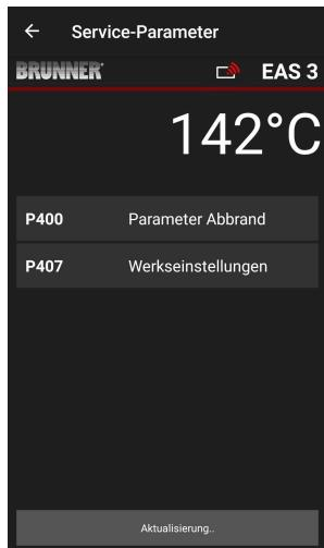
Etter automatisk overføring av data vises de aktuelle verdiene for hver parameter for det innstilte varmeelementet under **Parameter Abbrand = Burn-up parameters.**
