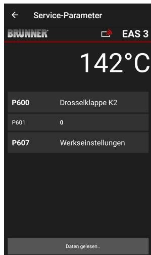
P602 tot P606 worden weergegeven als P601 is ingesteld op „1“, d.w.z. de gasklep is geconfigureerd:
