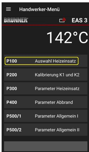
Stisknutím tlačítka **Auswahl Heizeinsatz** = Vybrat topný prvek otevřete nabídku P100. Kliknutím na řádek s topným **Heizeinsatz** = prvkem otevřete vyskakovací nabídku.
