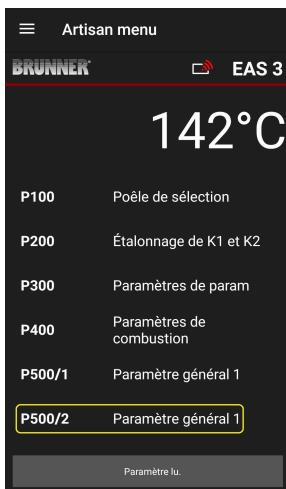
Dans ce menu, on peut régler les paramètres généraux partie 2 (P513 - P517). Les plages de valeurs sont visibles dans le *guide de programmation (chapitre paramètres généraux)*.
