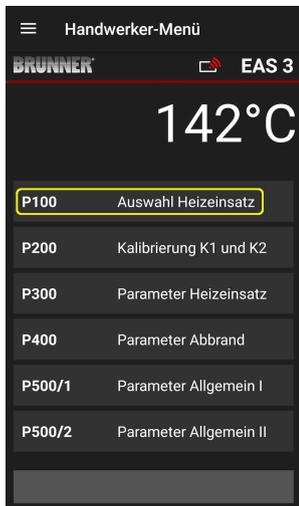
Trykk på knappen **Auswahl Heizeinsatz= Velg varme element** for å åpne P100-menyen. Klikk på linjen med **varmeelementet = Heizeinsatz** for å åpne en hurtigmeny.
