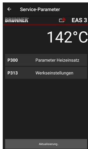
După transmiterea automată a datelor, la **P300 Parameter Heizeinsatz = P300 Heating element parameters (Parametrii elementului de încălzire )** apar valorile actuale pentru fiecare parametru pentru elementul de încălzire setat.
