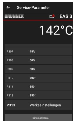
Parametrii elementului de încălzire pot fi re-setați făcând clic pe **ultimul parametru din setările din fabrică**. Pentru a face acest lucru, meniul pop-up trebuie confirmat cu **Jetzt rücksetzen = Reset now (Resetare acum)**.
