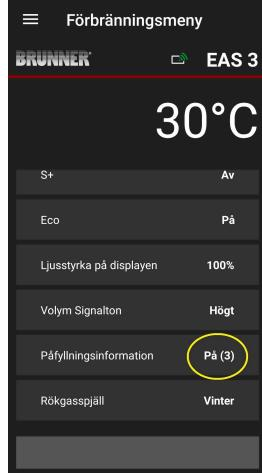
Den valda konfigurationen visas inom parentes under menyn för förbränning. (här exempel: konfiguration 3)
