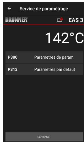
**Sous P300 Paramètres d'insert de chauffage (Paramètre Heizeinsatz)** les valeurs actuelles de chaque paramètre d'insert de chauffage apparaissent après la transmission automatique des données.
