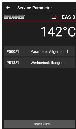
Текущие значения для каждого параметра отображаются под **P500/1 Parameter Allgemein 1 = P500/1 Общий параметр 1** после автоматической передачи данных.
