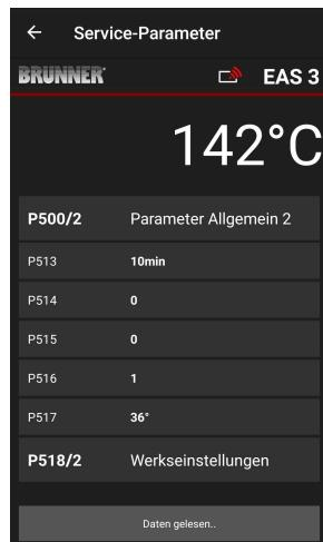
De parameters voor de burn-off kunnen worden gereset door te klikken op de laatste parameter **Fabrieksinstellingen**. Hier voor moet het pop-upmenu worden bevestigd met **Jetzt rücksetzen = Reset nu**.
