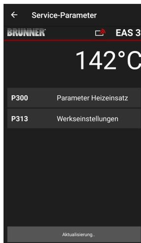
После автоматической передачи данных в разделе **P300 Parameter Heizeinsatz = P300** Параметры нагревательного элемента отображаются текущие значения каждого параметра для установленного нагревательного элемента.
