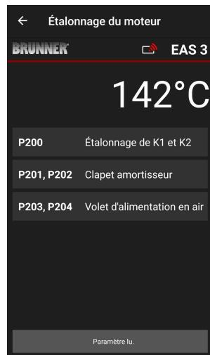
Cliquez **Start P201** → Le moteur passe à 100 % puis il passe à 0 %. Maintenant, le moteur peut être calibré manuellement. Pour cela, appuyez sur **+ ou -**.
