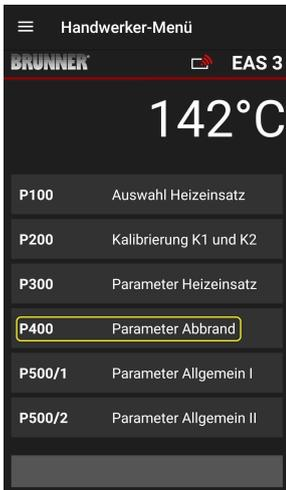
I denne menyen kan du stille inn parametrene for brenningen. Verdiområdene finner du i *programmeringsinstruksjonene* på (kapittelet *Burn-up parameters*).
