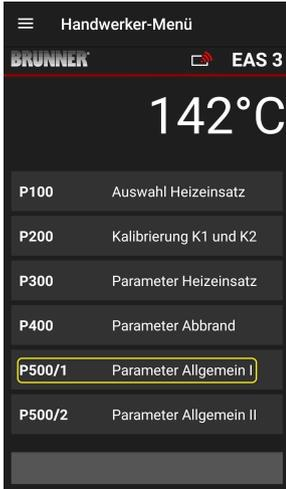
I denne menyen kan du stille inn de generelle parametrene i del 1 (P501 - P512). Verdiområdene finner du i *programmeringsveiledningen* (kapittelet *Generelle parametre*).
