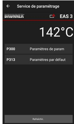
Sous **P300** Paramètres d'insert de chauffage (**Parameter Heizeinsatz**) les valeurs actuelles de chaque paramètre d'insert de chauffage apparaissent après la transmission automatique des données.
