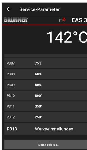
Parametrii elementului de încălzire pot fi re-setați făcând clic pe **ultimul parametru din setările din fabrică**. Pentru a face acest lucru, meniul pop-up trebuie confirmat cu **Jetzt rücksetzen = Reset now (Resetare acum)**).
