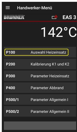
Apăsați butonul **Auswahl Heizeinsatz** (=Selectare element de încălzire) pentru a deschide meniul P100. Faceți clic pe linia cu **Heizeinsatz** (=elementul de încălzire) pentru a deschide un meniu pop-up.
