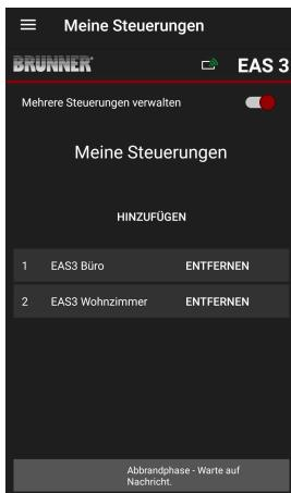
14. Nel menù „**Combustione**“ si può scegliere la EAS3 da controllare:
