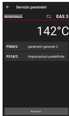
Sotto **P500/2 Parametri generali 2** compaiono in automatico i dati trasmessi, i valori attuali per ogni parametro.
