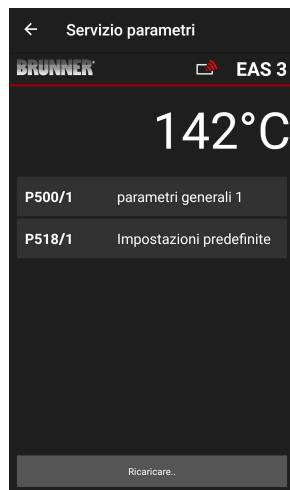
**Sotto P500/1 Parametri generali 1** compaiono in automatico i dati trasmessi, i valori attuali per ogni parametro.
