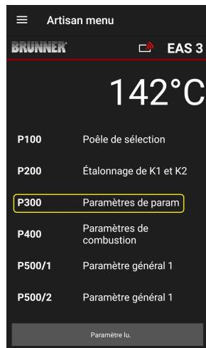
Ce menu permet de régler les paramètres d'insert de chauffage.
