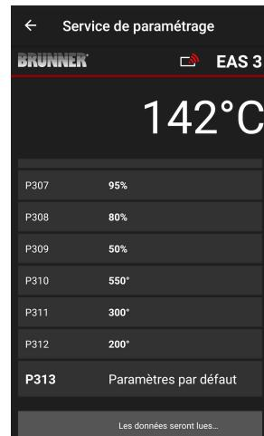
Les paramètres d'insert de chauffage peuvent être réinitialisés en cliquant sur Réglages d'usine (**Werkseinstellungen**). Pour cela, il faut confirmer le menu contextuel en cliquant sur Réinitialiser maintenant (**Jetzt rücksetzen**).
