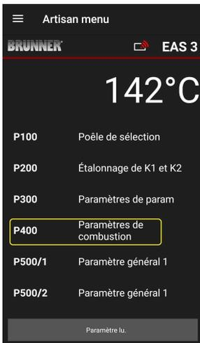
Dans ce menu, il est possible de régler les paramètres de la combustion.
