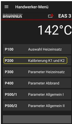
Stisknutím tlačítek **Kalibrierung K1** a **K2** = **Kalibrace K1 a K2** otevřete nabídku. **P200** pro kalibraci motoru.
