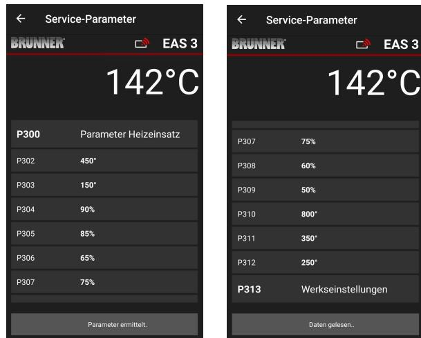
Параметры нагревательного элемента можно сбросить, нажав на **последний параметр Заводские настройки**. Для этого во всплывающем меню необходимо подтвердить команду **Jetzt rücksetzen = Сбросить сейчас**.
