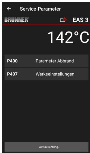
După transmiterea automată a datelor, la **Parametrii de ardere** (= **Parameter Abbrand**) apar valorile actuale pentru fiecare parametru pentru elementul de încălzire setat.
