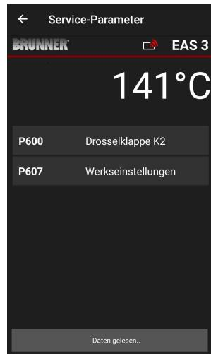
Valorile actuale pentru fiecare parametru apar la **P600 Clapetă de limitare a tirajului K2** după transmiterea automată a datelor:
