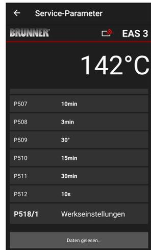
De parameters voor de burn-up kunnen gereset worden door op de laatste parameter **Werkseinstellungen = Fabrieksinstellingen** te klikken. Hiervoor moet het pop-up-menu bevestigd worden met **Jetzt rücs-etzen = Reset nu**.
