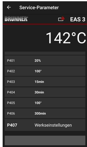
Параметры прожига можно сбросить, нажав на последний параметр **Заводские настройки** (= **Werkseinstellungen**).
