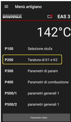
Premendo il pulsante **Calibrazione K1 e K2** si apre il **Menù P200**, che permette di eseguire la calibrazione del motore.
