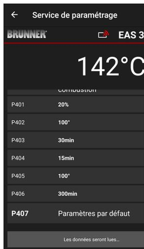
Les paramètres de combustion peuvent être réinitialisés en cliquant sur **Réglages d'usine (= Werkseinstellungen)**. Pour cela, il faut confirmer le menu contextuel en cliquant sur **Réinitialiser maintenant (= Jetzt rücksetzen)**.
