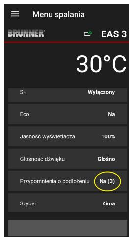
Wybrana konfiguracja jest wyświetlana w menu spalania w nawiasach. (tu na przykład: konfiguracja 3)
