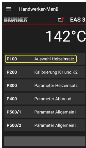
Stlačením tlačidla **Auswahl Heizeinsatz** = Vybrať vykurovací prvok otvorte ponuku P100. Kliknutím na riadok s vykurovacom **Heizeinsatz** = prvkom otvorte vyskakovacie menu.
