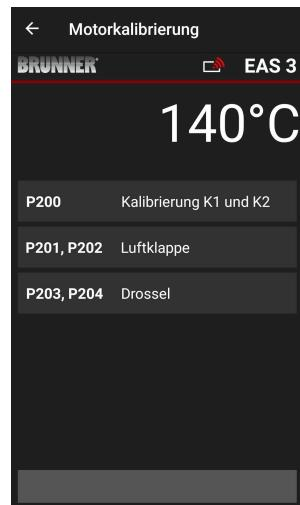
Klikk på **Start P201** → Motoren kjøres til 100 %, hvis ikke allerede gjort, og deretter til 0 %. Motoren kan nå kalibreres manuelt. Trykk på + eller - for å gjøre dette.
